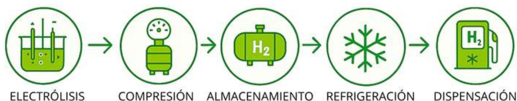
Figura 5. Esquema de producción de H_2 hasta su dispensación para vehículos. Fuente: Elaborada por los autores.
